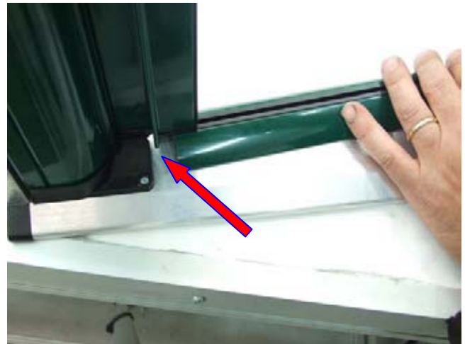
14° inserimento guida FurBy nella testata inferiore
