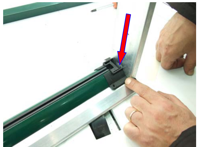
16° inserimento dello zoccolo con guida laterale
