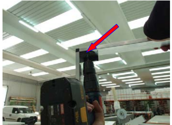
2° forare i due punti e fissare la cuffia
