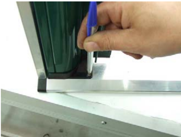
3° segnare la testata inferiore
