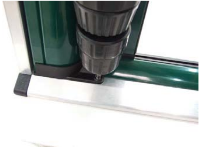
4° forare e fissare la testata
