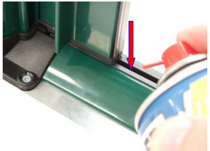
28° ogni 2/3 mesi spruzzare con dello spray al silicone
