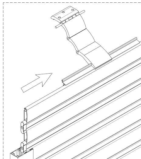
Posizionare gli anelli dei blocchi di sicurezza sul rullo e bloccarli mediante il serraggio di apposite viti, facendo attenzione a posizionare gli stessi in modo da non interferire, durante l'avvolgimento.
