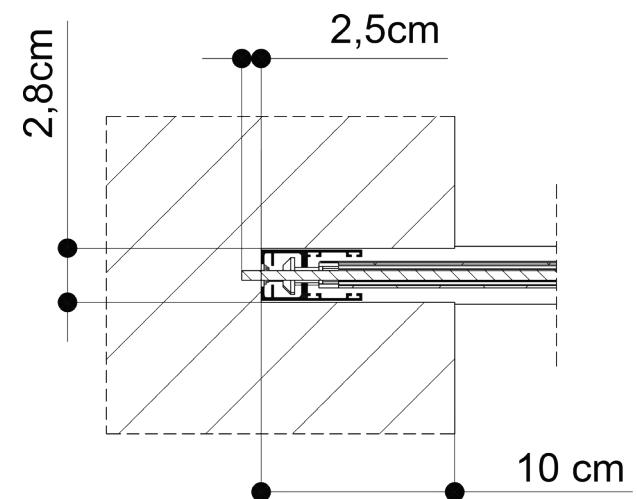
Fissare le guide in bolla, tramite apposite viti e/o tasselli che garantiscano una buona tenuta in base al supporto. Il fissaggio deve essere ad un interasse di 15 cm. Evitare il serraggio eccessivo, al fine di prevenire deformazioni delle guide e conseguenti malfunzionamenti (fig. C e D).
