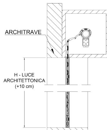
ATTENZIONE: per l'installazione della newSolar® secure 4 - newSolar® secure 3 è necessario l'utilizzo del rullo con diametro 70mm e spessore 15/10.
