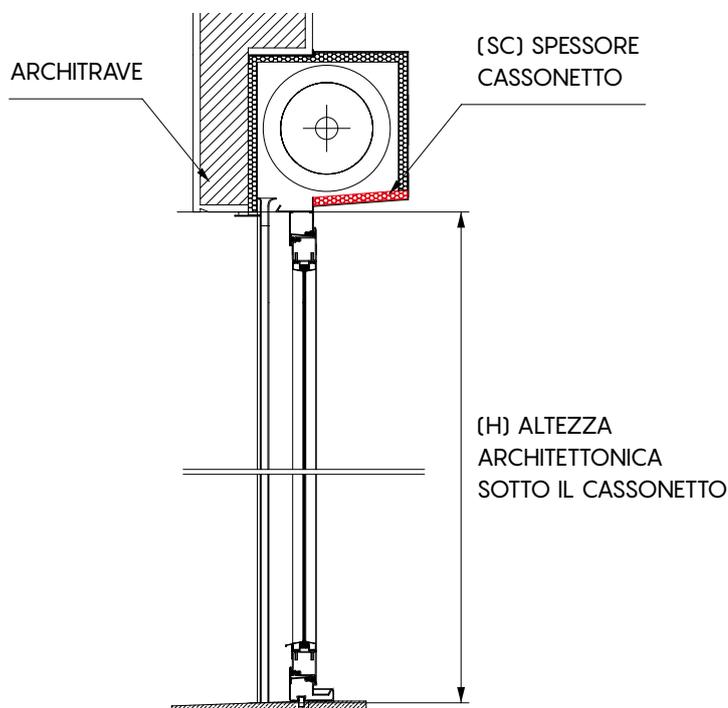
Per la determinazione dell'altezza finita, alla misura dell'altezza architettonica sotto cassetto H, aggiungere 10 cm fino ad un SC di 5 cm ( $H + 10$  cm).
