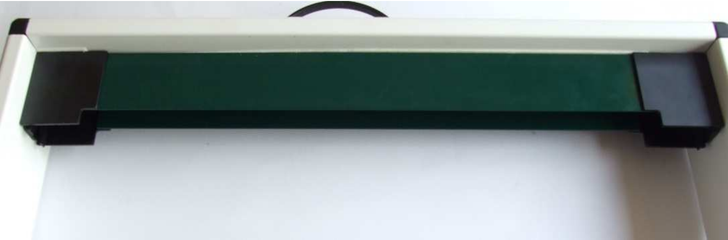
5 Fissare con il biadesivo la guida alta a soffitto insieme alle due cuffie (pulire bene il vano a soffitto prima di fissare)
