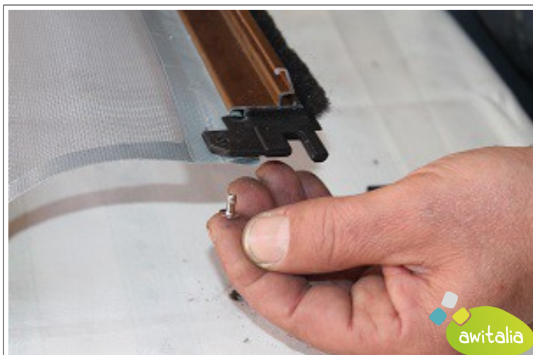
33- Inserire il rivetto maschio dalla parte dietro
