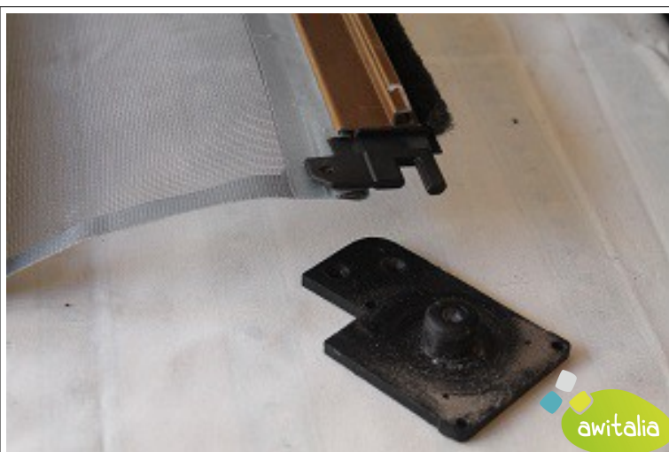
32- Fai un foro alla tasca/fettuccia per il rivetto
