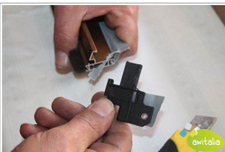
10- Sfilare il corsoio barra maniglia
