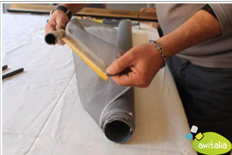
18- Staccare la rete dal rullo attaccata con bioadesivo
