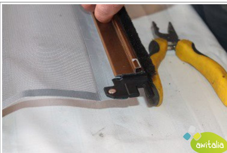
34- Inserire il rivetto femmina dalla parte avanti e batti
