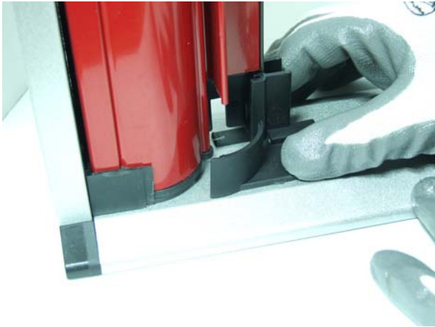
4 Fissaggio copritestata dx-sx
